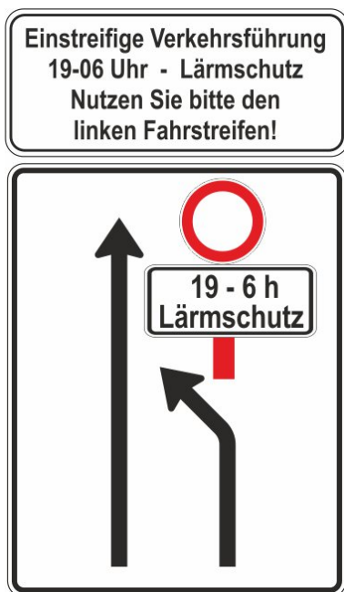
Abb. 7.3 Temporäre Einziehung eines Fahrstreifens aus Lärmschutzgründen
