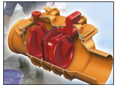
Abb.: Schnitt einer Rückstau-doppelsicherung für fäkalienfreies Abwasser. Die Rückstauklappen öffnen sich nur in Ablafrichtung. Von außen zurück drückendes Wasser wird abgesperrt. (Quelle: Kessel)
