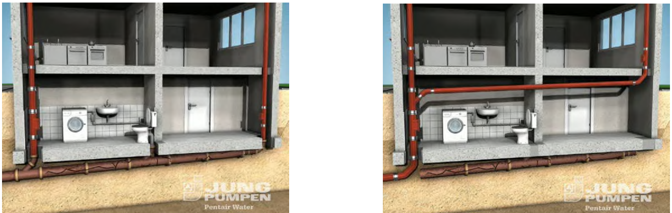
Abb.: Erneuerung einer schwer zugänglichen Leitung durch stilllegen des Altröhres und abhängen der neuen Leitung unterhalb der Decke. Die Hebeanlage mit Rückstauschleife für die Toilette ist hier noch nicht implementiert. (Quelle Fotos: Jung Pumpen)
